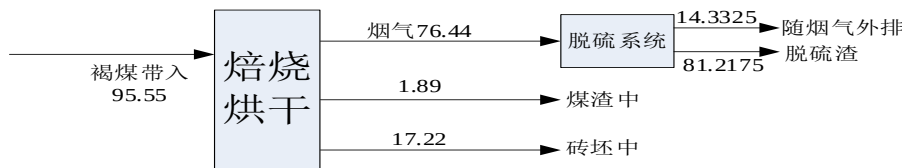
图 5.1-4 项目硫平衡图 (单位: t/a)
